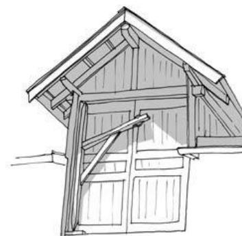
**Lucarnes traditionnelles** : Une lucarne est une baie verticale placée en saillie sur la pente d'une toiture, pour donner du jour, de l'aération ou l'accès au comble. La lucarne est composée d'une
